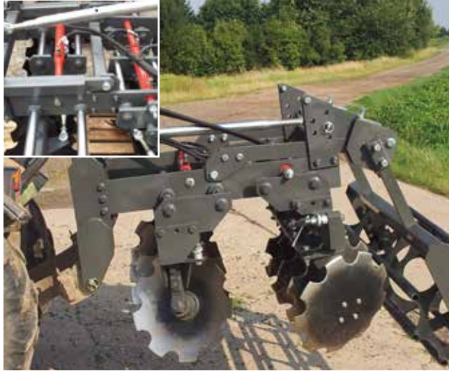
Arado de discos (ajuste de anchura)
