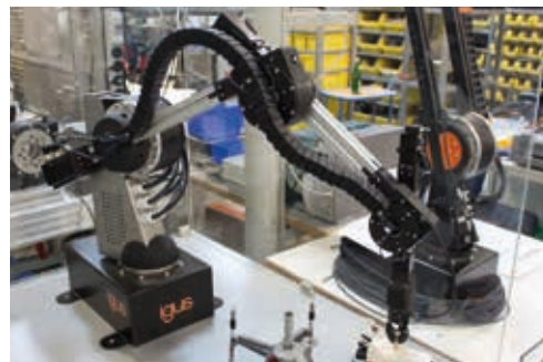
Trade fair machine RL-DQ-RBT-5532S-AC with 5 DOF and 3-finger gripper Messemaschine RL-DQ-RBT-5532S-AC mit 5 DOF und 3-Finger Greifer (igus® GmbH)
