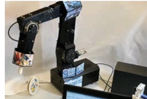
Camera-based control of a sensorless RL-D arm with 5 DOF Kamera-basierte Steuerung eines sensorlosen RL-D Arm mit 5 DOF (RoVi Robot Vision, TU Munich, LMT)
