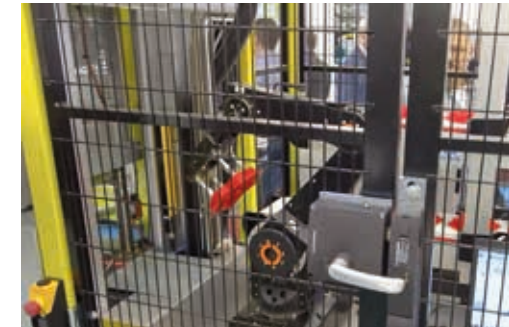
Injection-moulding process with automated handling thanks to robolink® D with 4 DOF Spritzgussprozess mit automatisiertem Handling dank robolink® D mit 4 DOF (Dr. BOY GmbH & Co. KG)
