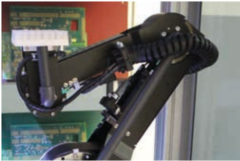
robolink® D for checking printed circuit boards robolink® D zur Überprüfung von Leiterplatten (4Stars Engineering Systems GmbH)
