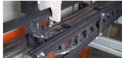
lokchain prototype in a fatigue test in the igus® laboratory lokchain als Prototyp im Dauertestversuch im igus® Labor
