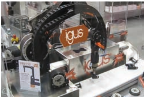
Trade fair machine – 5 DOF robot arm with RL-D and RL-S joints. System simulates real use in the igus® factory Messemaschine – 5 DOF Roboter- arm mit RL-D und RL-S Gelenken. Anlage simuli- ert echten Einsatz in der igus® Fabrik
