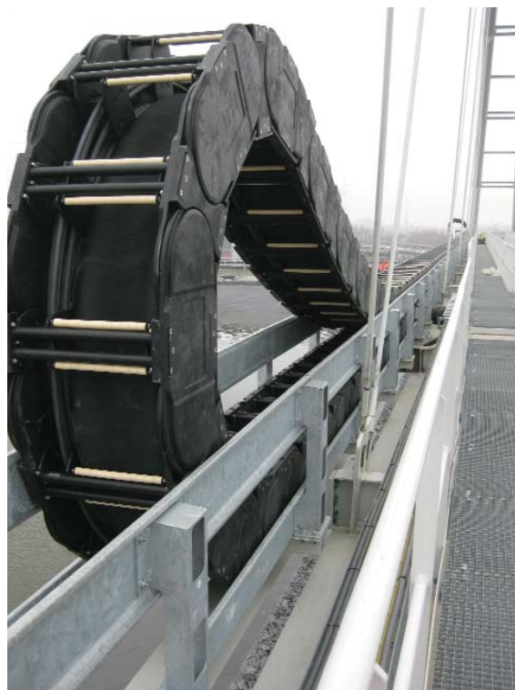
Foto PM1712-02: igus GmbH, Colonia Mangueras pesadas: El jurado concedió el "vector" de plata al proyecto Amoras en la ciudad belga de Amberes. La cadena portacables de plástico más grande del mundo (E4.350) transporta cuidadosamente mangueras de 300 mm de diámetro y aprox. 100 kg de peso por metro de manguera.
