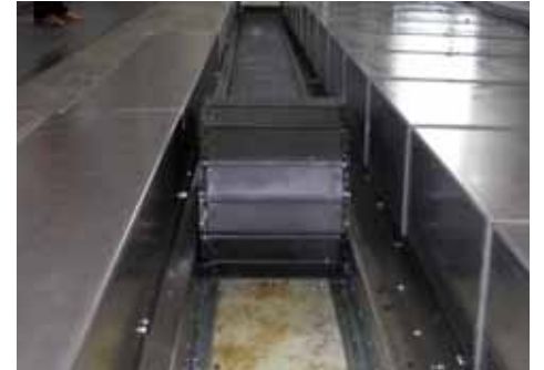
Tubo con más de 20 m de carrera en una máquina herramienta E-Tube with more than 20 m travel on a machine tool
