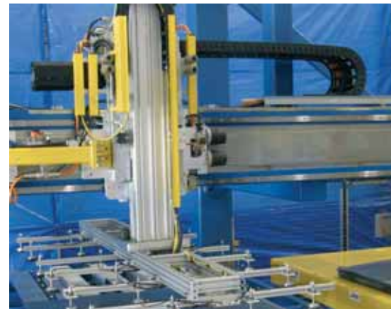
Aplicación horizontal, importante longitud autosoportada para movimientos rápidos en robots pórticos Horizontal application, large unsupported length for fast movements on a gantry robot
