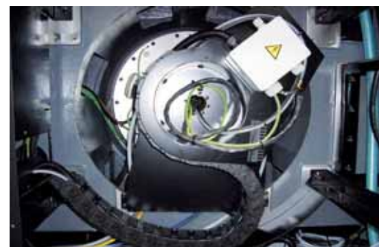
Ahorro de espacio: serie 2700 en máquina herramienta de 5 ejes Space saving: series 2700 on 5-axes-machine tool
